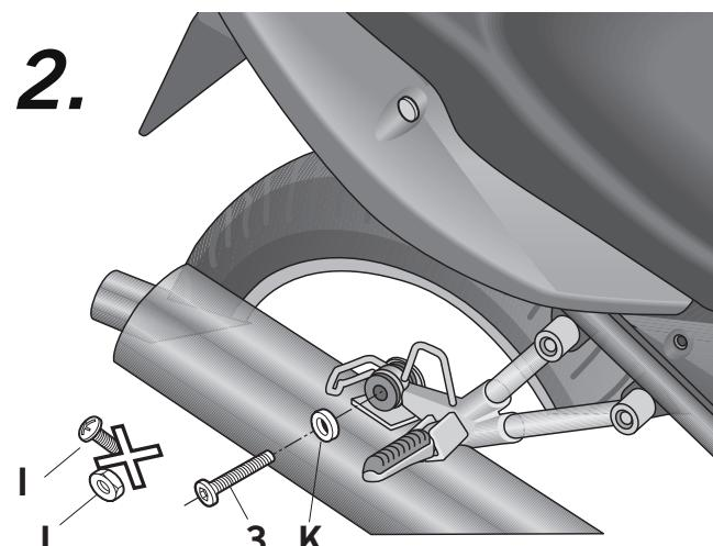
(E) De la zona derecha de la moto desmontar y desestimar del tubo de escape el tornillo (I) y la tuerca (J), y la arandela (K) que no se desestima. Montar el tornillo (3) y la arandela (K).
