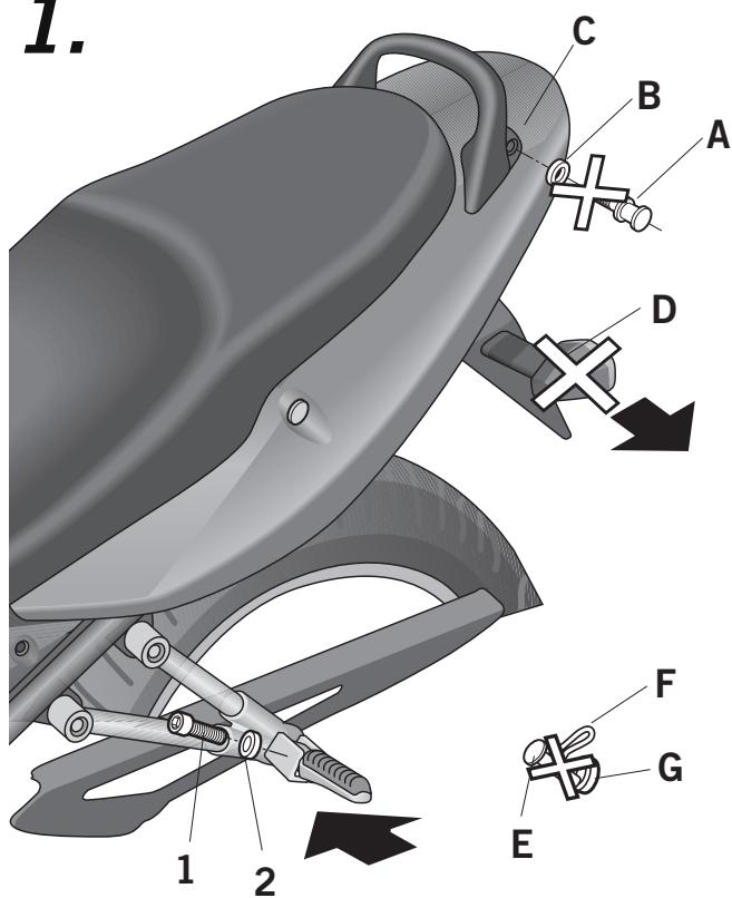
(E) Desmontar y desestimar los tornillos (A) y las arandelas mecanizadas (B) en zona (C). Desmontar y desestimar los intermitentes (D). **Nota importante para desmontar el sistema de estribera izquierda:** Realizar este paso con sumo cuidado para no desmontar en su totalidad la estribera. Desmontar y desestimar el pasador (E) y circlips (F) y la arandela (G) y montar en su lugar el tornillo (1) y la arandela (2).
